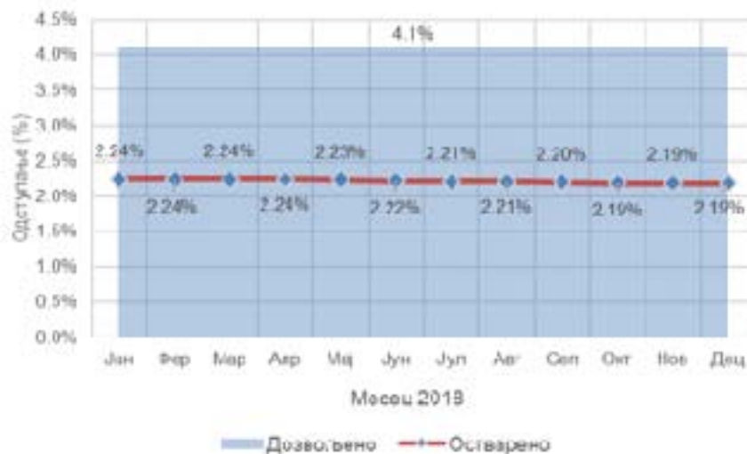
Слика 20. KEP - индикатор одступања путање у последњем поднетом плану лета у односу на путању по великом кругу у Србији и Црној Гори у 2018. години 5
